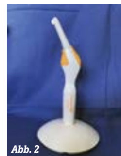
Abb. 1: Die lichtaktivierte Desinfektion umfasst drei wesentliche Komponenten: a) eine Lichtquelle, b) eine lichtempfindliche Substanz (Photosensitizer), c) Sauerstoff. Abb. 2: FotoSan® 630 (CMS Dental, Kopenhagen, Dänemark) LED-Lampe (emittierende Diode) im roten Spektralbereich. Klassifikation DS/EN 60601-1:1998, 93/42/EEC, EN 60825-1:2001 Ed1.2. Wellenlänge: 620-640 nm, Lichtintensität: 2000-4000 mW/cm 2 . Abb. 3: Das FotoSan 630 emittiert Licht im roten Spektrum bei 630 nm und ermöglicht die Aktivierung des Toluidinblaus.
